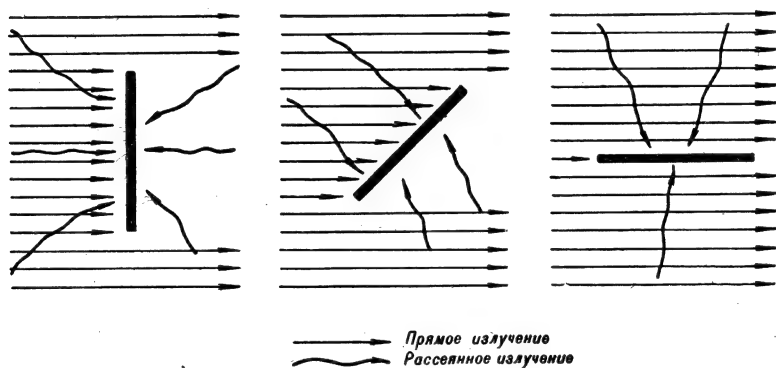
Рис. 55. Зависимость количества светового излучения, падающего на поверхность, от угла падения
